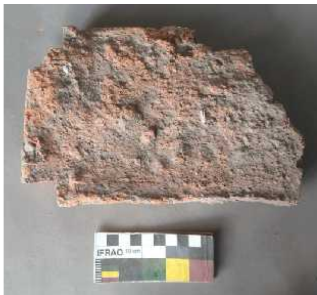
Figura 6.40. Muestra del sitio Sanatorium, donde no se ven oquedades ni presencia de inclusiones y se nota una coloración homogénea (SF 1)
