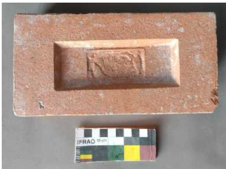
Figura 8.41. Ladrillo producido en máquina industrial hallado en el contexto de excavación del sitio Sanatorium donde se puede notar el sello de la Fabrica La Etrusca de Rosario, Santa Fe
