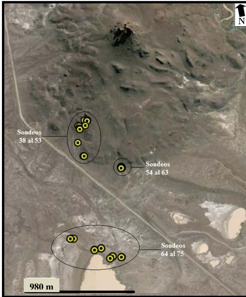
Figura 8.2.3.29. Localización de los sondeos en el sector oeste-sudoeste de cerro Ventana.
