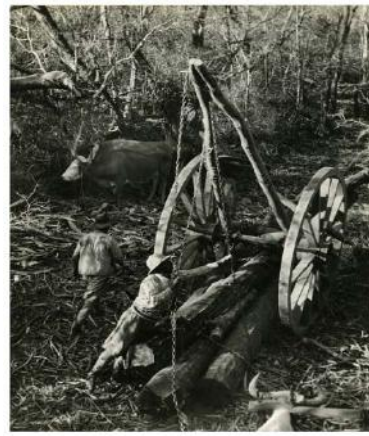
Figura 25C. Trabajador en el monte utilizando alzaparilla para subir los rollizos al carro cachapé. Archivo General de la Nación.
