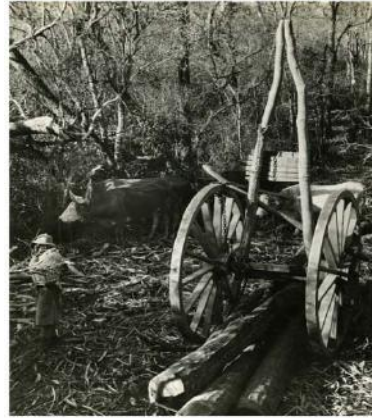
Figura 25 A. Trabajador en el monte utilizando alzaparilla para subir los rollizos al carro cachapé. Archivo General de la Nación.
