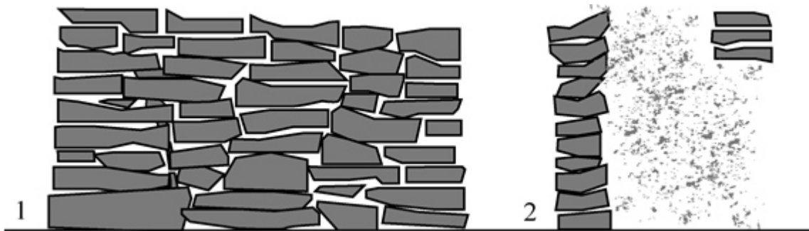
Figura 7.10. Muro con cimientos empotrados. 1. muro empotrado dibujado de frente, 2. muro empotrado en articulación con muro simple dibujado de perfil.
