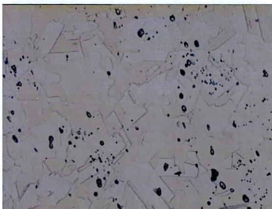
Fig. C.11 z 345 Micrografía correspondiente a la zona más externa al filo. Se observa una microestructura de granos recristalizados y maclas de recocido junto a líneas de deformación.
