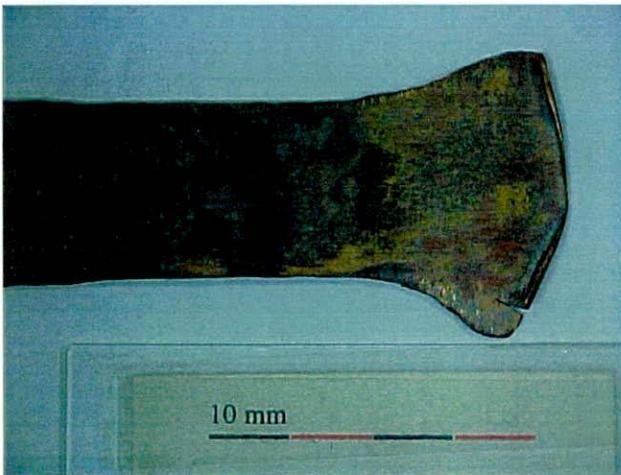
Fig. C.18 Extremo redondeado de pieza nº 9 sometida a corte (30 veces) y picado (30 veces), también en madera. Nótese las diferencias de alteración en relación a la Fig. C.17.
