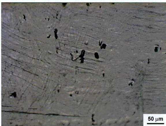
Fig. C.1 73- 158? Metalografía tomada en el área más alejada del filo. Se observan granos equiaxiados y maclas de recocido, mientras que las líneas de deformación son muy escasas.
