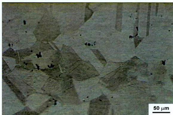
Fig. C.4 73-158? Metalografía de la zona suspensión. Obsérvese las diferencias estructurales en relación a las figuras anteriores que indican menor intensidad de martillado de la pieza tras su último recocido, en tanto se visualizan granos recristalizados junto a maclas de recocido.
