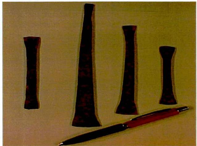
Fig. C.17 Extremo de pieza nº 9 sometida a 15 eventos tipo corte sobre algarrobo, que sufrió severa deformación del filo, el cual se arqueó hacia delante.
