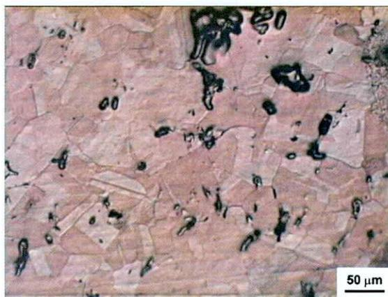
Fig. C.6 z 63 (47-1209) Metalografía tomada próxima al borde del filo donde se ubican líneas de deformación atravesando los granos equiaxiados.
