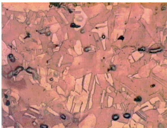
Fig. C.10 z 345 Micrografía tomada en la zona interna del filo donde se visualizan maclas de recocido en granos equiaxiados.
