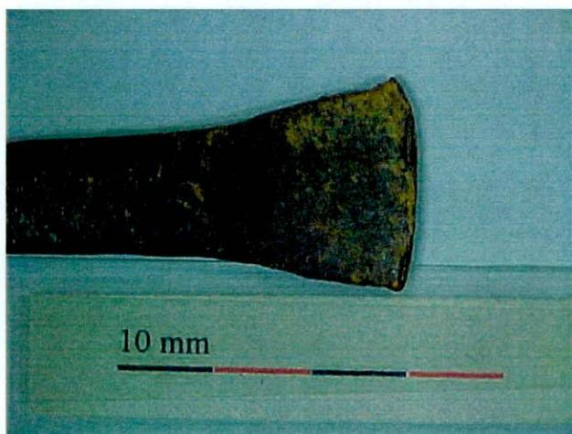
Fig. C.19 Extremo proximal de pieza n° 4 empleando como percutor un guijarro. Hubo levantamientos del material hacia ambos lados de la pieza.
