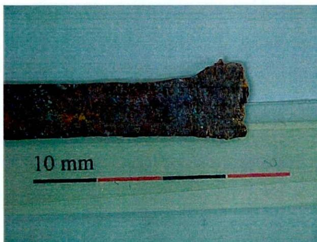
Fig. C.21 Extremo distal con esquirlas de pieza n° 14 tras el sometimiento a corte (30 eventos) sobre algarrobo.
