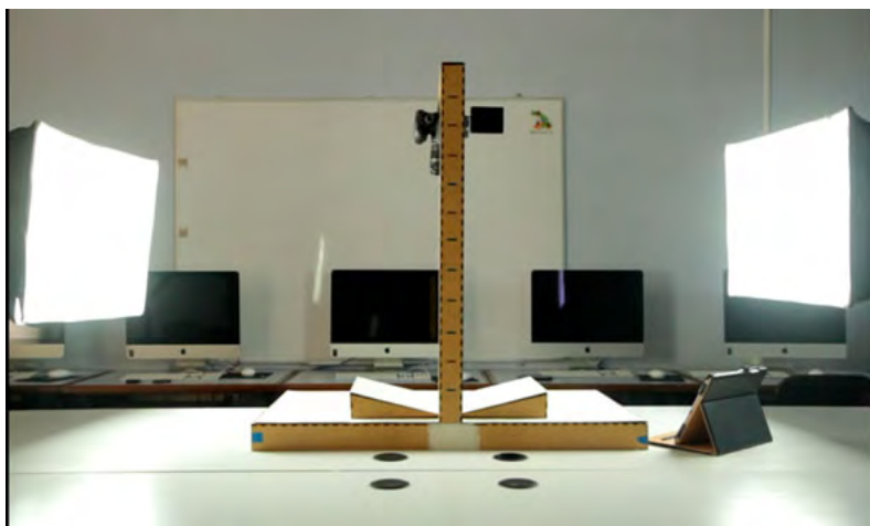
Figura 5. Prototipo de escáner aéreo con cámara y equipo de iluminación
