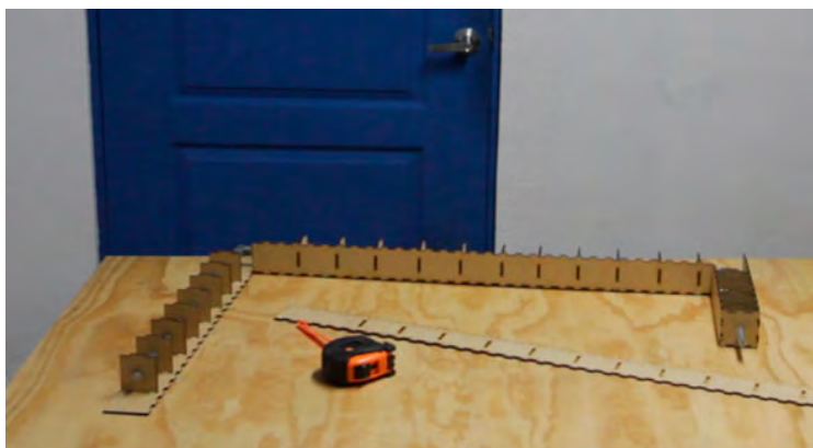
Figura 3. Brazo de soporte con la barra roscada en su interior
