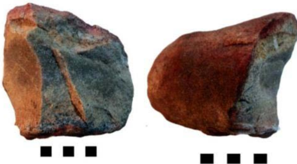
Figura 7.35. Núcleo de arenisca silicificada, de donde se obtuvieron las muestras para los cortes delgados. Nótese los diferentes grados de silicificación a medida que se observa desde la corteza hacia el centro del núcleo.
