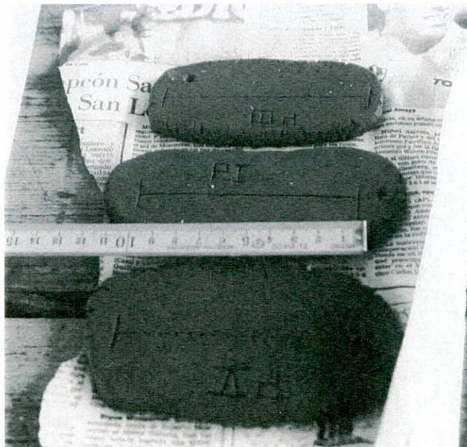
Foto 8.6: Plaquetas para control de la contracción de la pasta.
