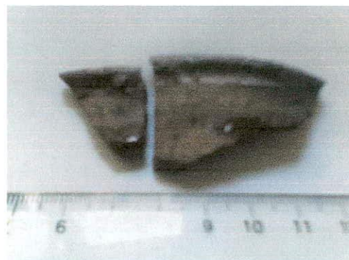
Imagen 6.72 adhesivo totalmente despegado
