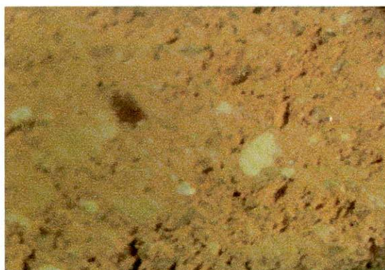
Imagen 5.5 Microfotografía de pasta grupo B Detalle de color de la pasta e inclusiones blancas
