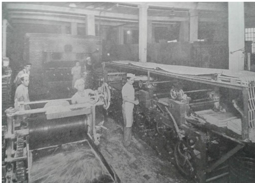
Foto 14 Vista interior del taller de fabricación de galletitas de la fábrica de Luis Botto y Cía. En la imagen se ve a los operarios varones, junto a los hornos y las máquinas de extensión y corte de la masa horneada. “Serie expositiva y gráfica de nuestra potencia industrial”, Revista de la Asociación Fabricantes de Dulces, Conservas y Afines, 3/ 1942, 15.
