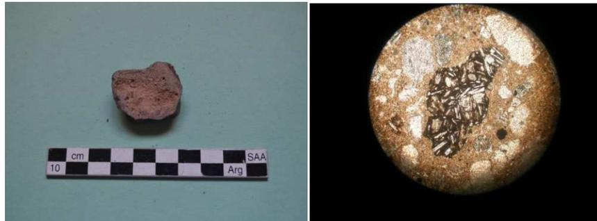
**Figura 34.** LA. Argamasa. (22). Izquierda fragmento, derecha corte petrográfico sin nicoles
