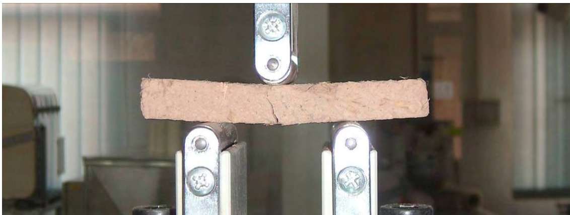
Figura 9.16. Detalle de ensayo de resistencia a la flexión de una muestra de adobe.
