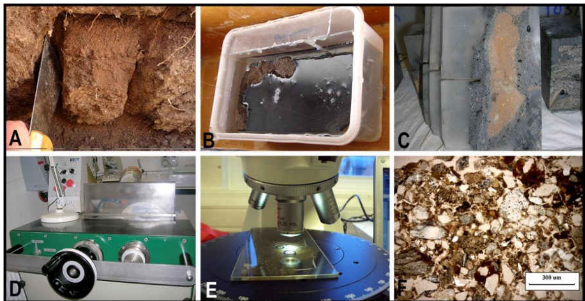
Figura 2.8. A- Muestreo estructurado en el campo. B- Luego del secado, impregnación con resinas (epoxy o polyester en cámara de vacío). C- Tras el fraguado de la resina, corte de bloques para pegar en el portaobjetos y D- pulir a aproximadamente 25/30 \mu\text{m} . E- Observación de la lámina delgada en un microscopio petrográfico de luz polarizada. F- Corte en microscopio, sin analizador.
