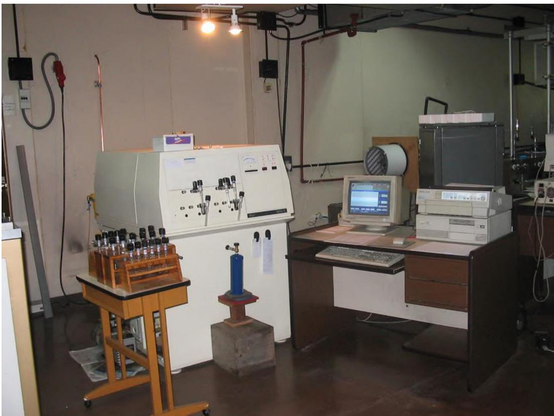
Figura 7.11. Espectrómetro de masas Finnigan MAT Delta V, con sistema *off line* en funcionamiento en INGEIS.
