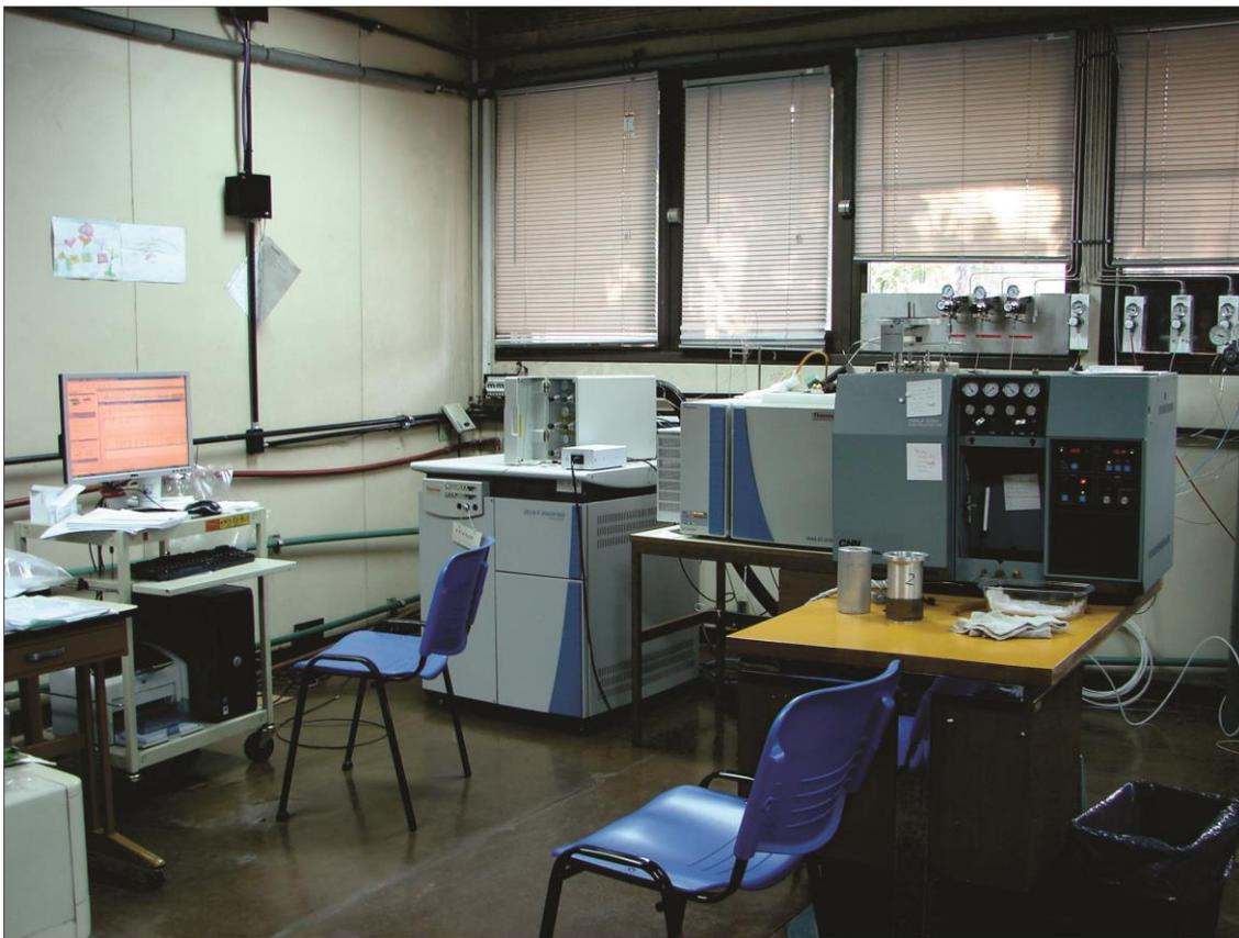
Figura 7.10. Analizador Elemental – Espectrómetro de masas de relaciones isotópicas (sistema *on-line*) en funcionamiento en INGEIS.
