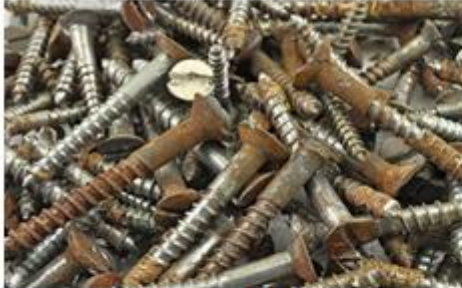
Oxidación del hierro
