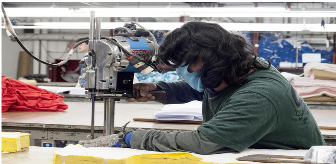
**Cortador trabajando con máquina de corte sobre mesa de corte. Utiliza uniforme, barbijo y guantes de trabajo. También se pueden observar las telas apiladas que conforman un mismo corte. Fuente: página web de la empresa, 2015**
