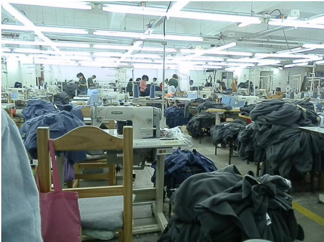
**Módulo de costura, posiblemente con costureros/as en horario de almuerzo. Se pueden observar máquinas de costura en uso con paquetes de cortes en tela polar sobre bancos de apoyo laterales y sillas de madera con sus almohadones. Por detrás, trabajadoras de mesa paradas, revisando las prendas. Fuente: página de FB de costureros de CAI, 2014**
