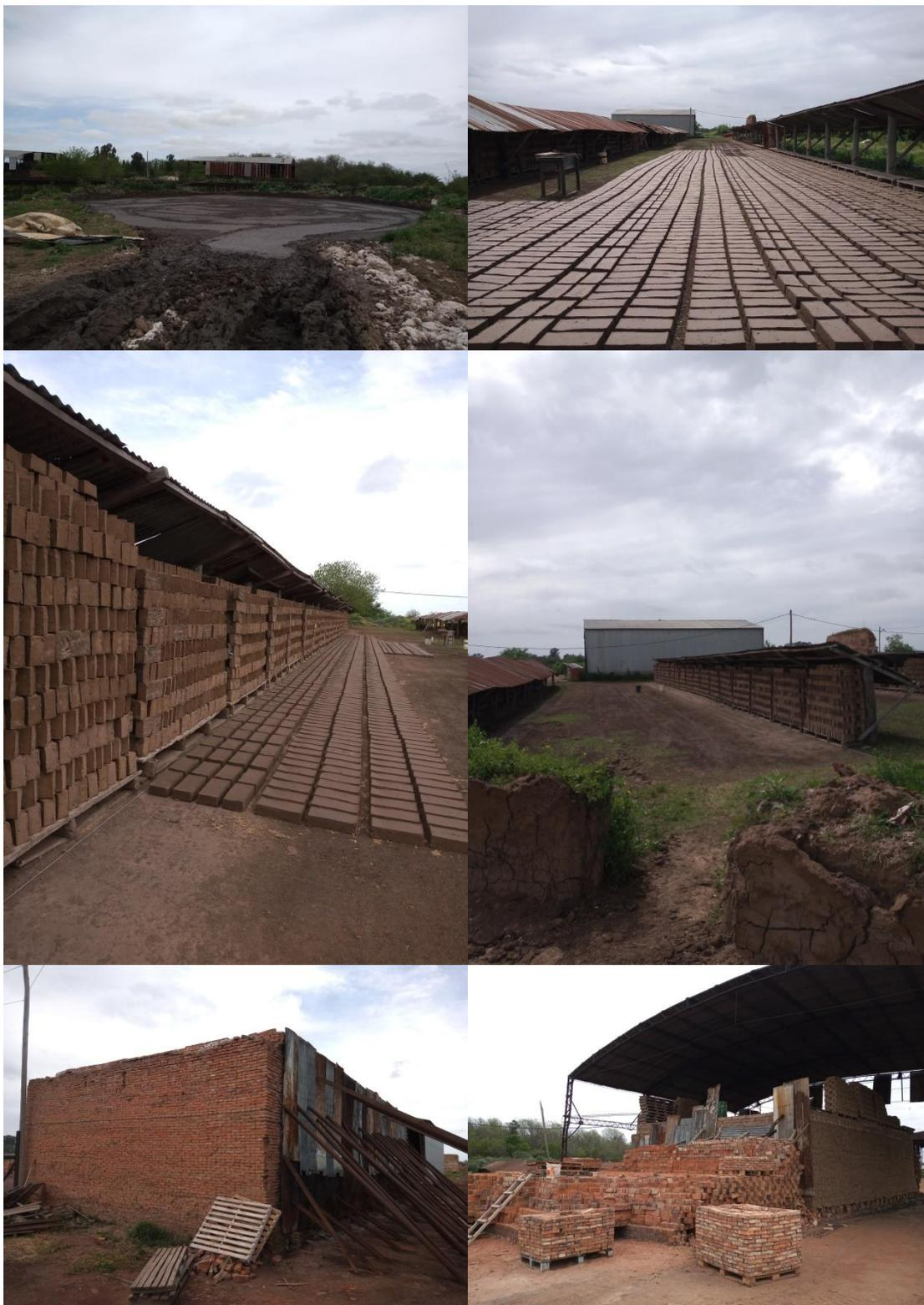
Arriba a la izquierda: mezcla en el pisadero. Arriba a la derecha y medio: canchas de corte y secado y apilado de ladrillos. Abajo a la izquierda: hornalla. Abajo a la derecha: ladrillos terminados.
