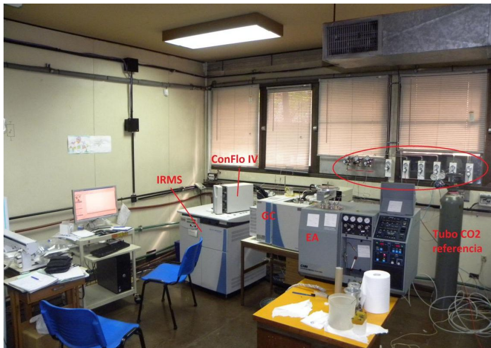
Figura 6.20. Equipo disponible en INGEIS para la medición de valores de \delta^{13}\text{C} y \delta^{15}\text{N} en materia orgánica.
