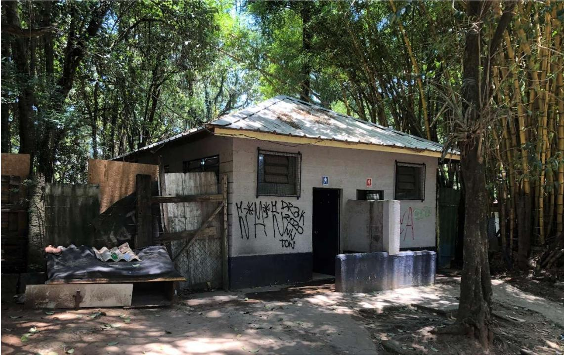
*Figura 123:* el único baño público del parque, que volvió a funcionar recientemente. Son visibles la precariedad de la construcción, el desorden de elementos constructivos, el vandalismo, así como la irregularidad del suelo cementado, perjudicando la movilidad, seguridad y accesibilidad. Archivo fotográfico del autor.
