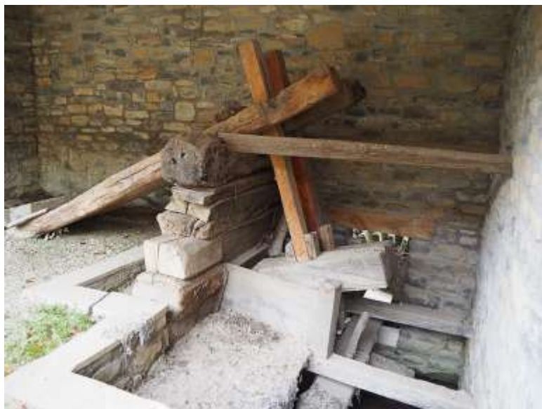
Fig. 22. Mecanismo interno restaurado de un molino batán. Fiscal, Huesca.
