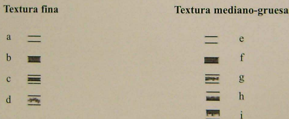
Figura 1. Dibujo de la apariencia de los cortes frescos con los tipos de núcleos más frecuentemente observables en los grupos tecnológicos en cuestión. En pastas de textura fina: a- Oxidación completa, b- Reducción completa, c- Oxidación incompleta con márgenes de núcleo rectos, d- Oxidación incompleta con márgenes de núcleo difusos. En pastas de textura mediano-gruesa: e- Oxidación completa, f- Reducción completa, g- Oxidación incompleta con márgenes de núcleo difusos, h- Reducción-oxidación, i- Oxidación-reducción. El grupo Ordinario (sin decoración) presenta los tipos e, f, g, h, i. El grupo Rojo pulido (Tlacara negro/rojo, Rojo monocromo) presenta los tipos a, c y d para el caso de piezas pequeñas y de paredes finas, y los tipos e y g para el caso de piezas de mayor tamaño y paredes más gruesas. El grupo Inka provincial presenta los tipos a y c.
