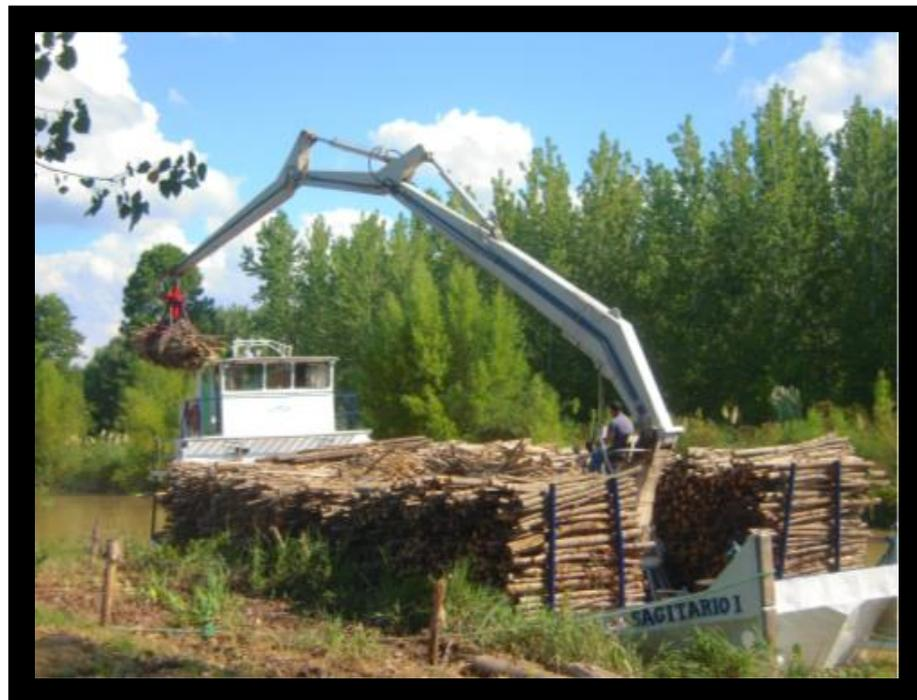
***Fotografía 11. Barco con pluma para transporte de madera. Fuente: Fotografía tomada por un miembro del equipo.***
