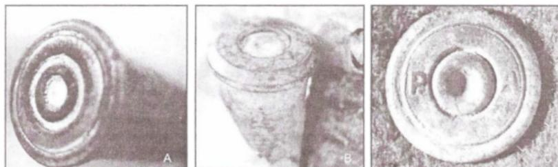
Figura 2. Tipos de vaina según las características del culote que se describen en la Tabla 2 : A. tipo 1, B. tipo 2 y C. tipo 3
