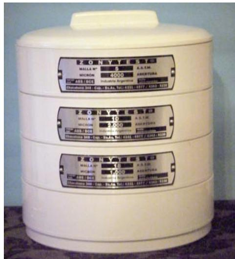
Foto 6.1a. Pila de tamices utilizados para separar los microvestigios del nivel 4.
