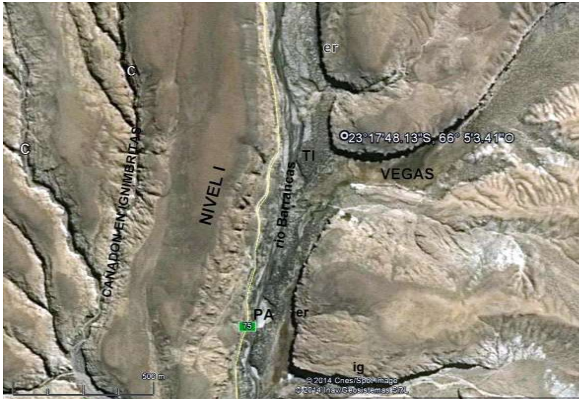
Figura 28. Geoformas en la cuenca media. Pedimentos del nivel I sobre ignimbrita (ig) a ambos costados de la foto. También se observan cañadones (c) que cortan el nivel I y la ignimbrita subyacente. En la parte central, se encuentra el cañadón del río Barrancas con terrazas fluviales (T1), la planicie aluvial (PA) y laderas labradas en roca (er). En este tramo se efectuó el perfil Cruces 1.
