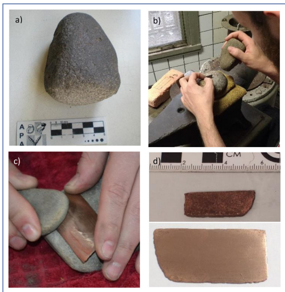
Figura 1. A) Lito utilizado como percutor para laminar la placa. B) Proceso de laminación por percusión. C) Pulido con lajas de pizarra. D) Pieza de fundición antes de la experimentación y placa laminada y pulida. La longitud de la pieza es de 65.5 mm.
